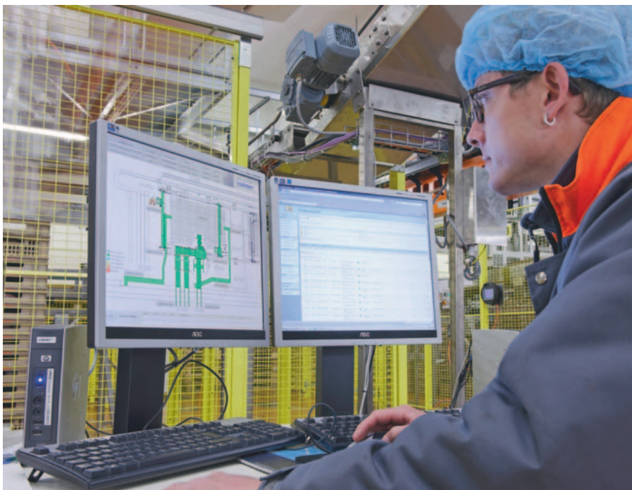
Das Prozessvisualisierungs- und -bediensystem auf der Basis WinCC ermöglicht die Überwachung der Anlage ChaKo (Charcuterie Kommissionierung) durch eine Person.
